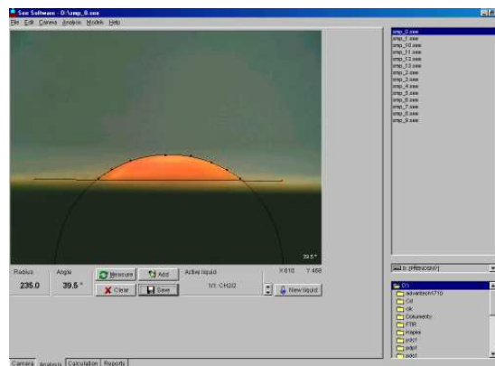
Obr. 17. Příklad měření úhlu smáčení [5].
