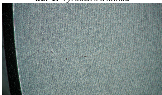
Obr 2: Makro připraveno v příčném řezu a na povrchu v místě vady
