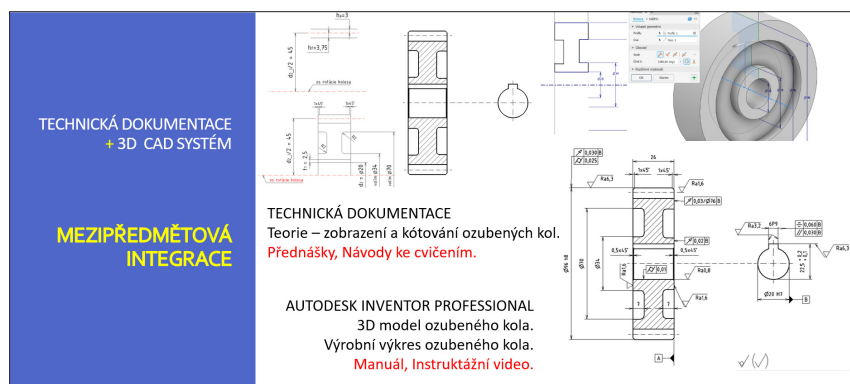
Obr. 4: Zobrazení a kótování ozubených kol.
