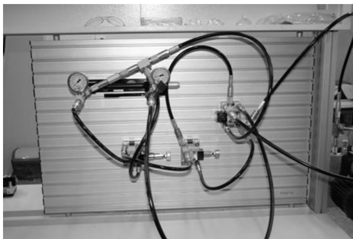
Rys. 3. Układ sterowania hydraulicznego z siłownikiem dwustronnego działania oraz regulacją prędkości ruchu tłoka (5).
