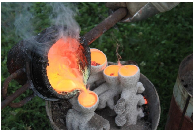
Obr 1: Lití bronzu do tenkostěnných keramických skořepin (archiv autora)
